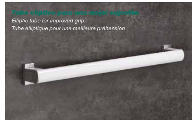
Manillones rectos. Tubo elíptico, 38 x 25 mm., epoxy blanco, antracita o anodizado, revestimientos de la fijación en resina sintética de color blanco o antracita, cromado mate o brillante. Fijaciones invisibles.
